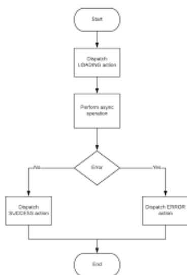
Σχήμα 5.3: Υλοποίηση λογικής του Redux Thunk Middleware.
